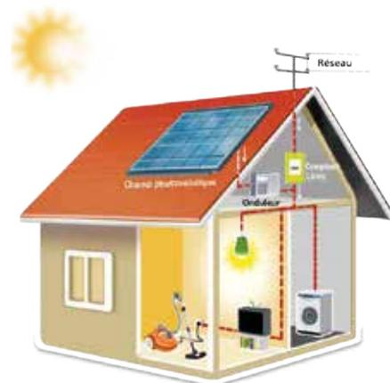
Schéma d'un système PV - PV - autoconsommation
